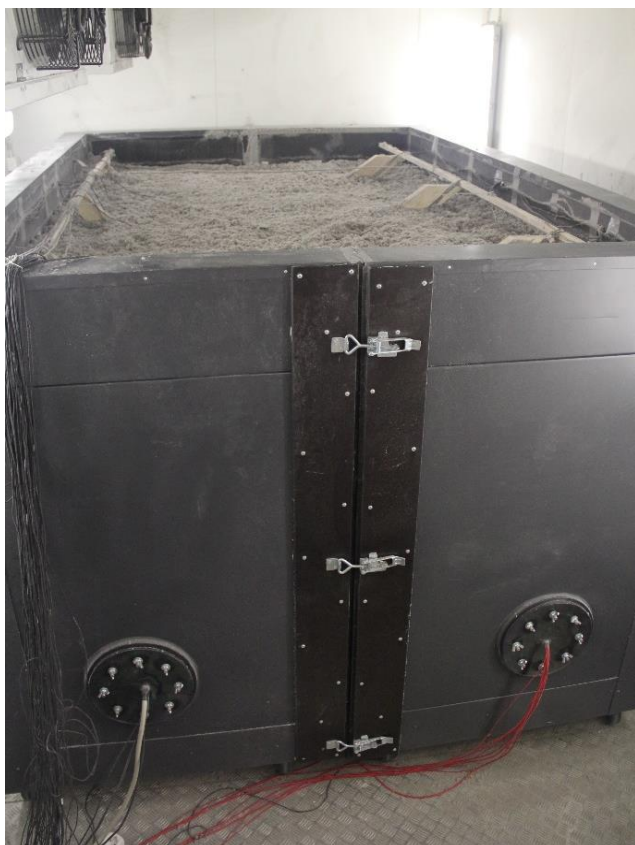
Kuva L1.4. Kuva tutkittavasta yläpohjarakenteesta asennettuna tutkimuslaitteistoon. Rakenteeseen on puhallettu 600 mm puukuitueristekerros.
