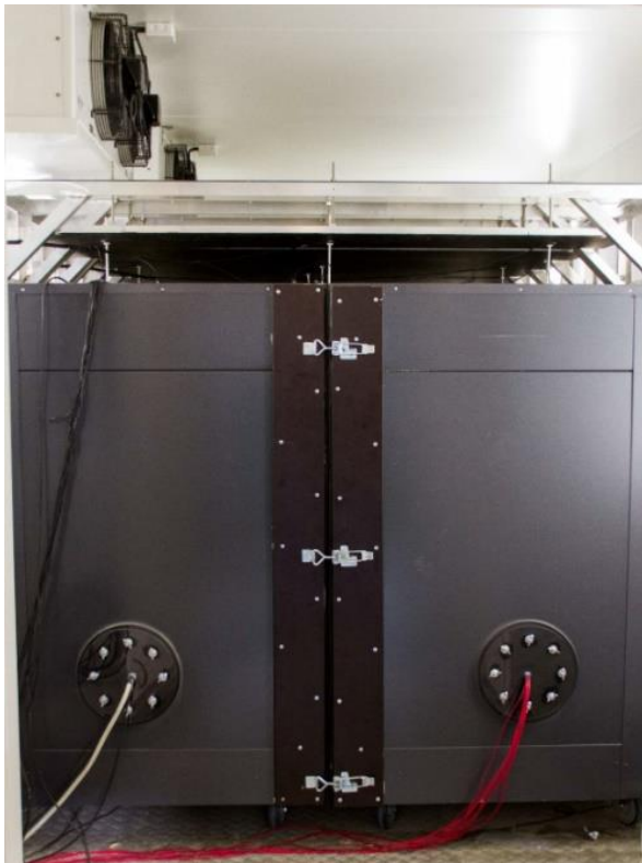
Kuva L3.3. Toimintavalmis yläpohjarakenteiden tutkimuslaitteisto, jossa suojakammio on nostettu laitteiston päälle.
